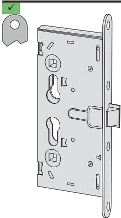
Cerradura antipánico, en el interior siempre actúa con el dispositivo antipánico o con la llave, en el exterior la llave condensa o descondensa la maneta y recoge la balda. La maneta exterior sólo recoge si está descondensada.
